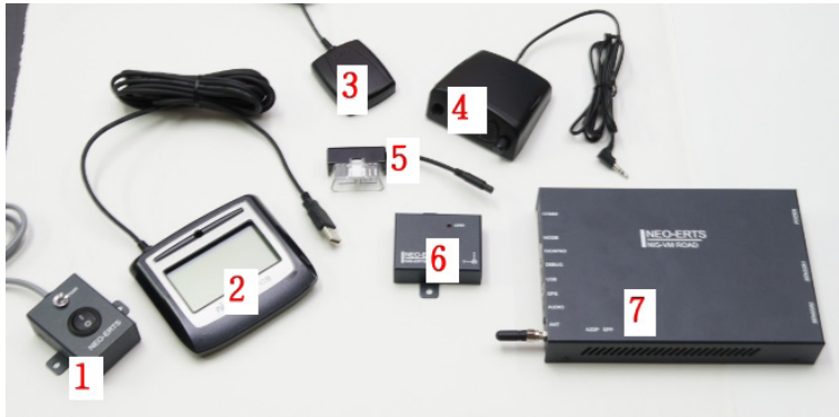
운전면허시험용 자동차 내에 탑재되는 장비들 1. 전원스위치 2. 동승자(참관인)로부터 서명을 받기 위한 서명패드 3. GPS 수신기 4. 스피커 5. ODB 인터페이스 6. 가속센서 : 급출발, 급제동 등을 감지 7. 차내의 각종 센서로부터 정보를 수집하는 중앙장치
