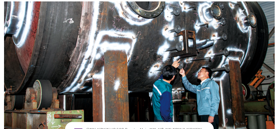
용접이 이루어진 HP SCR Reactor Main 부분. 이후 도장 작업으로 마무리된다.
